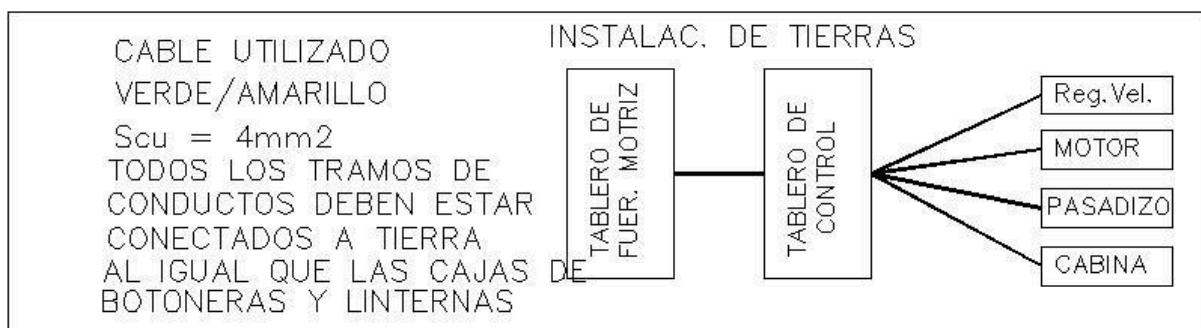
Conectar la toma de tierra al borne existente al pie del tablero, con cable de 2,5mm 2 de sección (o mayor). Es muy importante asegurar una buena conexión a tierra. Debe hacerse directamente a una jaula exclusiva para el ascensor. El mismo cable puede utilizarse para la puesta a tierra del motor y limitador de velocidad del ascensor, pero no se aconseja utilizar la tierra general del edificio, como tampoco el neutro.
